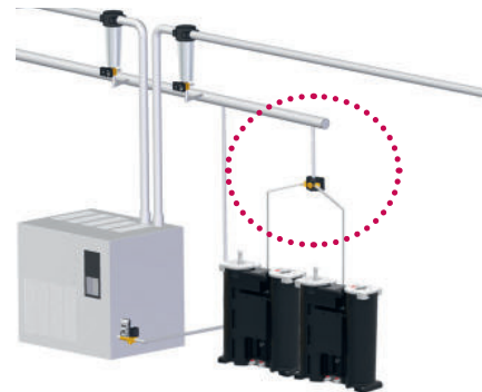
Eine typische Installation mit PURO-CT-DISTRIBUTOR
