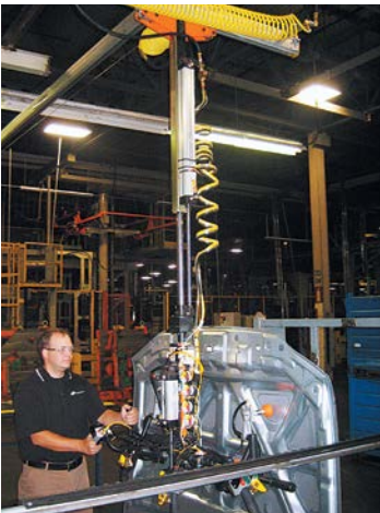
Drehmomentrohr mit integriertem Vakuum-Handhabungssystem
