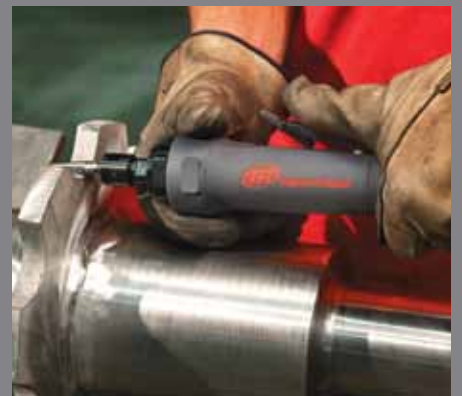
Entgraten und Schleifen von Kanten
