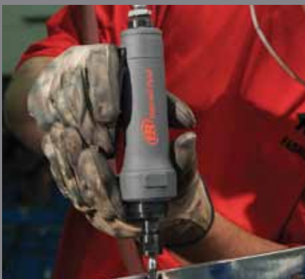
Säubern und Glätten nach Schweißarbeiten
