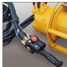
PHS-Steuerung (mit standardmäßigem Not-Aus- Schalter bei CE-Version)
