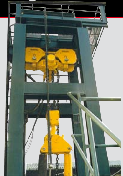
LCA500DIP3RE Druckluft- Hebezug mit Laufkatze auf Prüfstand
