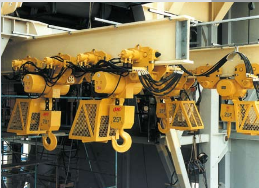
25-Tonnen-Hebezug auf Ölbohrinsel (LCH250QD).
