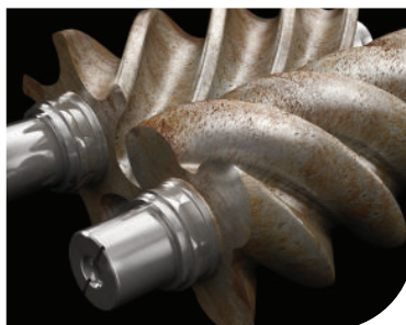
Schraubenkompressoren mit konventionellem Schmiermittel
